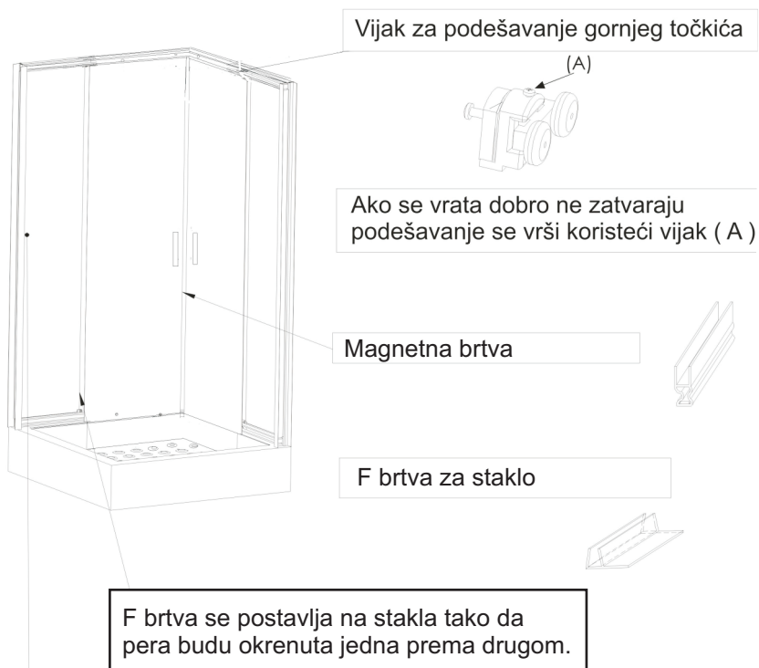
Slika 7. Postavljanje brtvi na stakla
